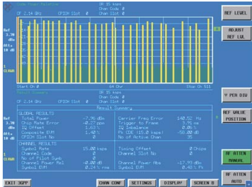
Измерение мощности WCDMA в кодовой области с помощью R&S®FSU R&S®FS-K72
