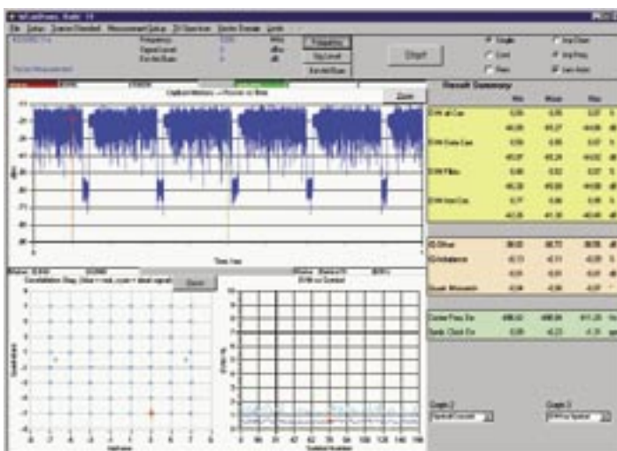
Измерение сигналов 802.11а; скорость передачи данных при модуляции 64QAM и одновременном отображении временных характеристик, сигнального созвездия, EVM на один символ OFDM и сводки результатов с отображением глобальной ошибки.
