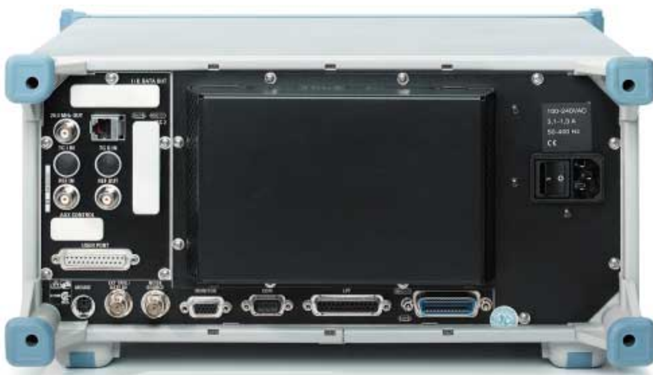
На виде сзади показаны разъемы следящего генератора, порта пользователя, LAN-интерфейса и другие входы и выходы
